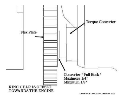
FIT UP THE STARTER MOTOR AND CHECK FOR PROPER RING GEAR TO PINION GEAR ENGAGEMENT. THE PINION GEAR OF THE STARTER SHOULD TRAVEL ½ TO 2/3 ACROSS THE FACE OF THE RING GEAR WHEN THE SOLENOID IS ACTUATED. PROPER ALIGNMENT OF THE STARTER TO RING GEAR IS OBTAINED WHEN THE REGISTER ON THE FRONT OF THE STARTER IS MATED TO THE OUTSIDE EDGE OF THE STARTER HOLE. TORQUE STARTER BOLTS TO PROPER VALUE.
